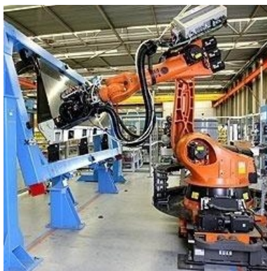
Figura 2. Robô de furação e rebiteagem - Stork-Fokker. [5]
