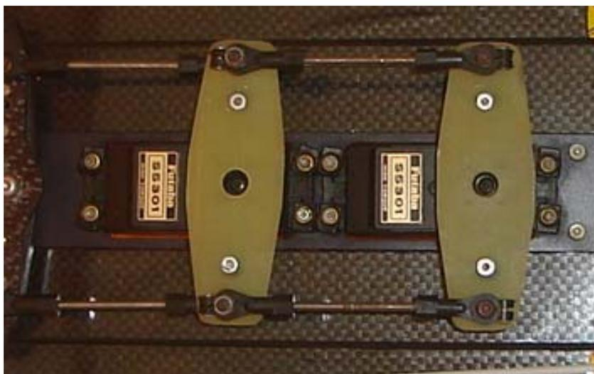
**Figura 6 - Montagem mecânica de redundância de servos-atuadores**
